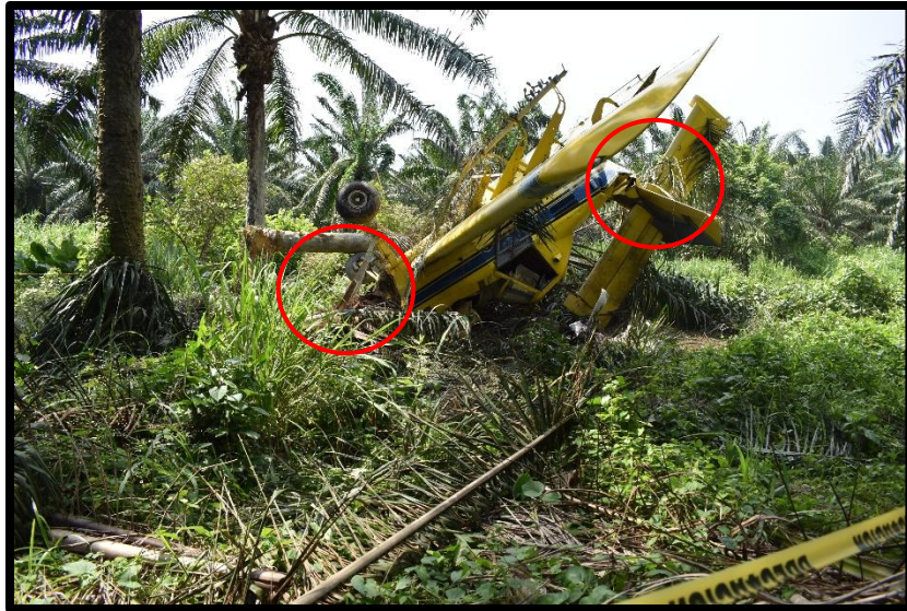
Fotografía No. 3 Daños en la sección de cola y motor.
